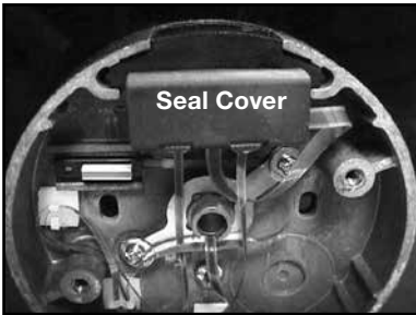
Figure 11 - Open ZIF Seal Cover
